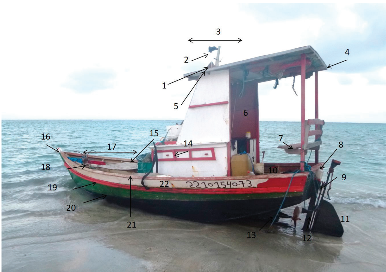
Figura 4 - Denominações das estruturas do barco construído pelo pescador de Tamandaré. Legenda: 1 - Farol de bombordo (vermelho, lado esquerdo); 2 - Farol de topo; 3 - Casa de comando; 4 - Parassol; 5 - Farol de boreste (verde, lado direito); 6 - Cabine; 7 - Banco de governo; 8 - Painei de Popa; 9 - Contra-cadastro; 10 - Sepo; 11 - Leme; 12 - Pé de galinha; 13 - Quilha; 14 - Bitaca; 15 - Boca de escotilha; 16 - Beque; 17 - Cavername; 18 - Carninga; 19 - Cintado; 20 - Linha d'água; 21 - Água morta (Borda de cima); 22 - Coral.
