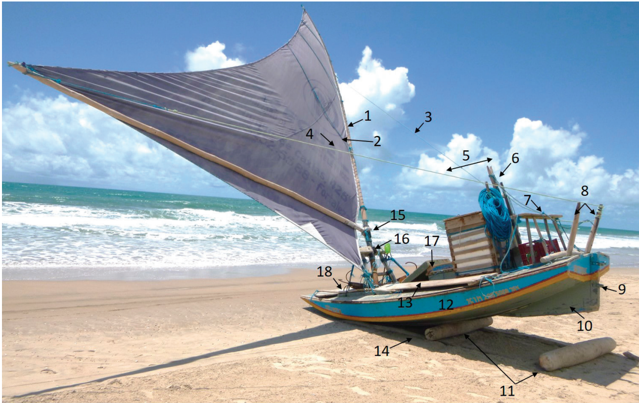
Figura 5 - Denominações das estruturas da jangada de vela utilizada pelos pescadores da Praia do Batoque, Ceará. Legenda: 1 - Mastro; 2 - Carregadeira (Corda); 3 - Escoto (Corda); 4 - Ligeira (Corda); 5 - Espeque; 6 - Forquilha de espeque; 7 - Banco de governo; 8 - Calçadores; 9 - Cadastro; 10 - Patião; 11 - Rolos; 12 - Fundo; 13 - Bolina; 14 - Calço de bolina; 15 - Forras; 16 - Mão de tranca; 17 - Banco de vela; 18 - Escotilha; 19 - Pau de cabestro.
