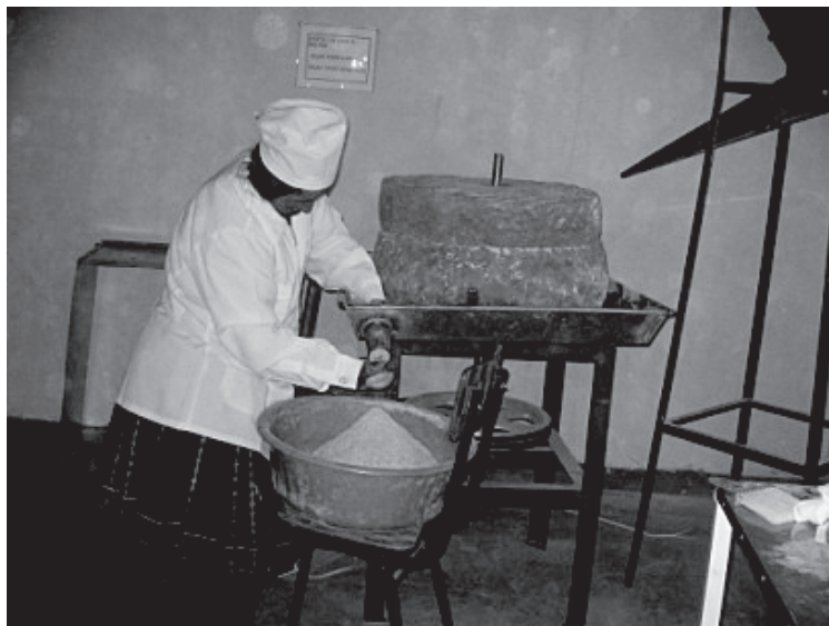
Figura 5. Innovación de molino de piedra para el procesamiento de pito o harina de cañahua ( Chenopodium pallidicaule Allen).
