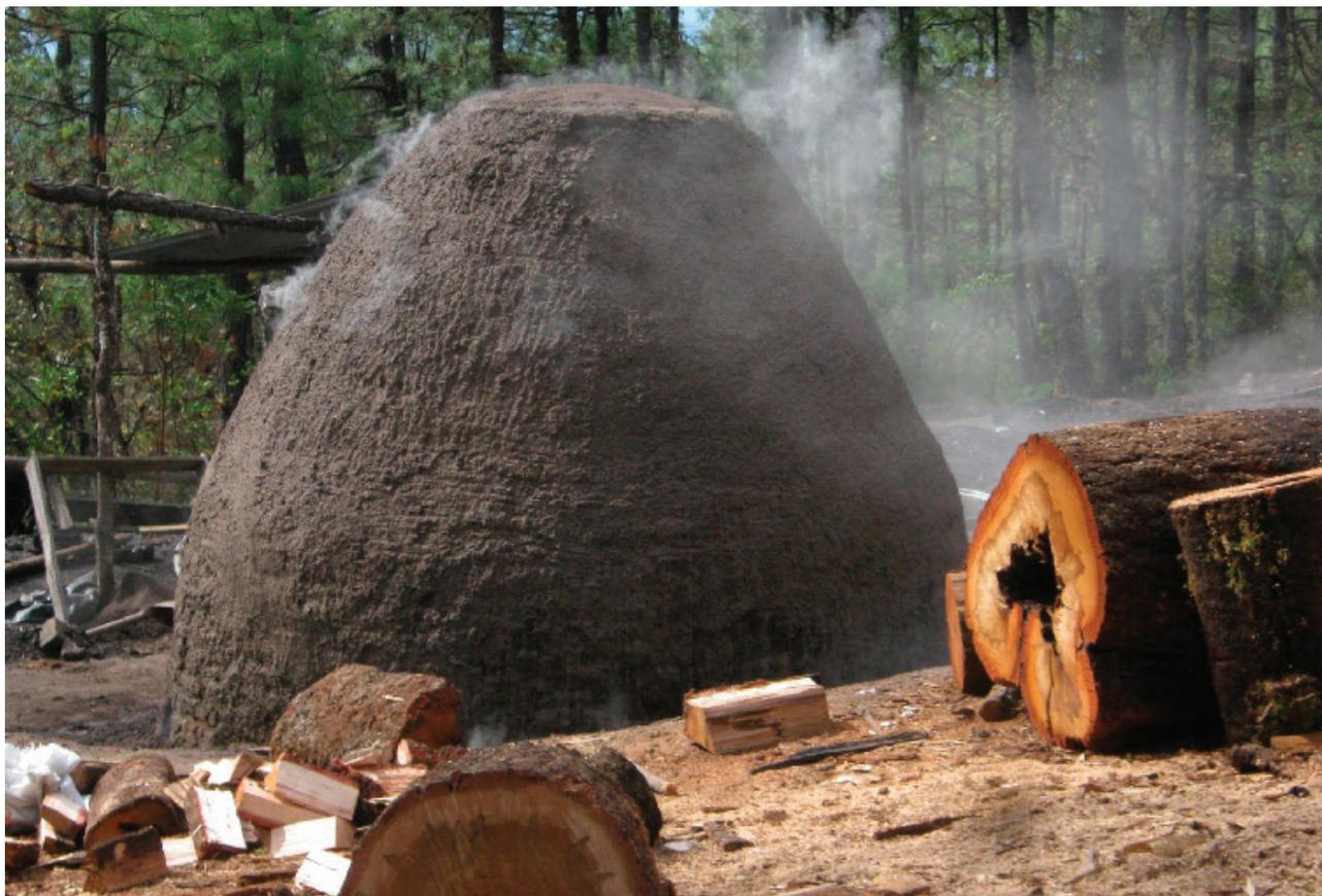
**Figura 9.** Horno para carbón de encino (*Quercus* sp.), Santiago Comaltepec, Oaxaca, México (Foto: Heike Vibrans).
